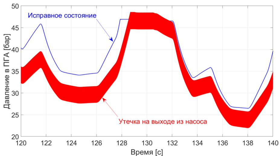
Рисунок 3. Переходные процессы изменения давления в пневмогидроаккумуляторе для исправной и неисправной ГС
