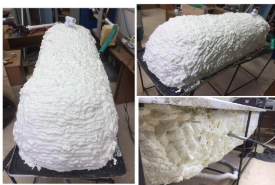
Рисунок 10. Внешний вид ёмкости после нанесения звукоизолирующего материала
