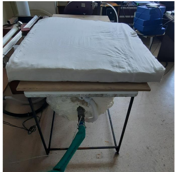
Рисунок 11. Внешний вид ёмкости после звукоизоляции
