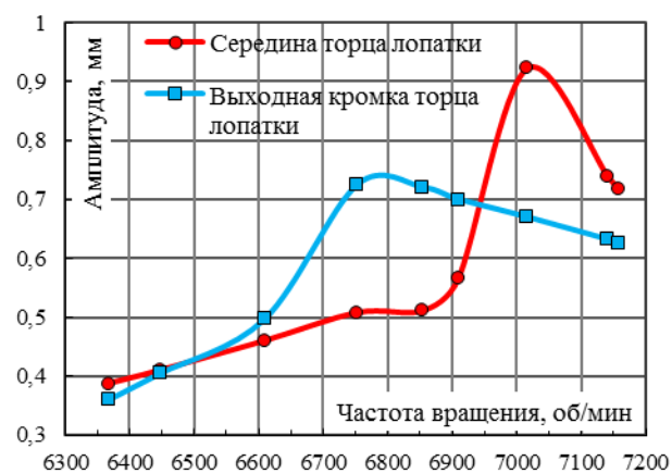
Рисунок 5. Изменение амплитуды колебаний различных частей торца пера 7-й лопатки 3-й ступени
