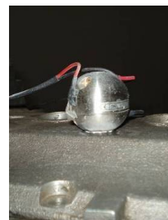
Рисунок 8. Закрепление вибровозбудителя в ходе модального анализа
