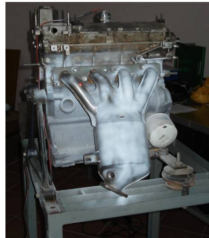
Рисунок 7. Экспериментальная установка по модальному анализу каталитического коллектора
