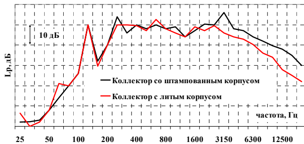
Рисунок 3. Третьоктавный спектр уровней звука при частоте вращения коленчатого вала 3800 об/мин в подкапотном пространстве моторного отсека
