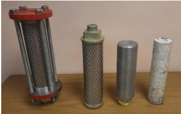
Рисунок 6. Внешний вид испытуемых глушителей
