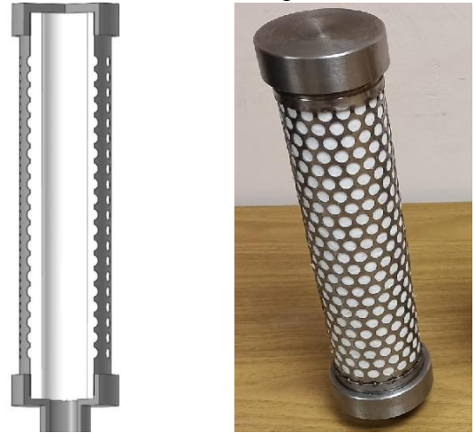
Рисунок 5. 3D-модель и итоговая конфигурация глушителя в сборке
