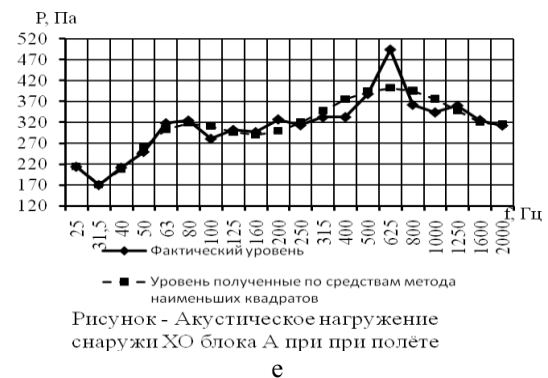
Рисунок 1. Результаты моделирования акустической нагрузки а, б – для МБО блока III ступени, в, г – для ПО центрального блока, д, е – для XO центрального блока
