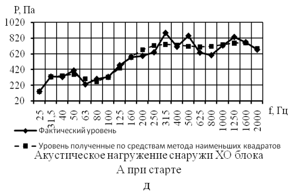
Рисунок 1. Результаты моделирования акустической нагрузки а, б – для МБО блока III ступени, в, г – для ПО центрального блока, д, е – для XO центрального блока
