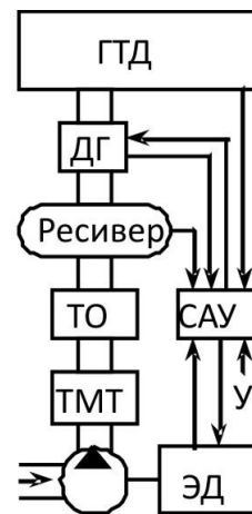
Рисунок 6. САУ НК-361 с двумя независимыми контурами
