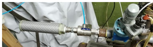
Рисунок 2. Внешний вид пневмоглушителя в составе экспериментальной установки по определению сопротивления продуванию
