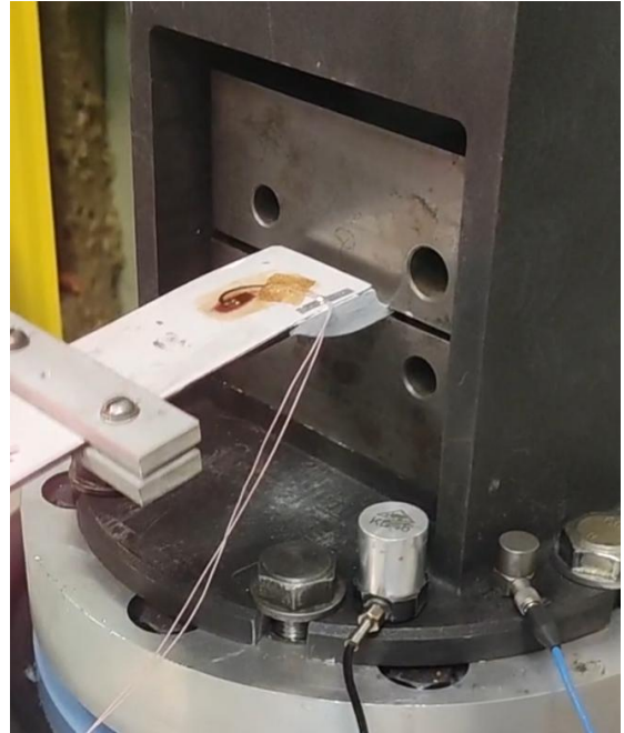
Рисунок 1. Схема испытаний образца на вибростенде
