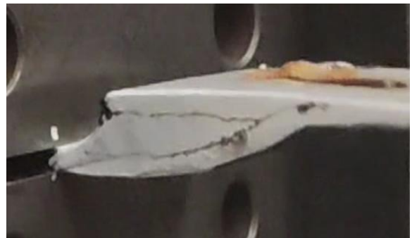
Рисунок 2. Вид трещины на конструктивно подобном образце композитного фланца
