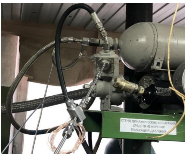
Рисунок 4. Узел испытательной камеры с датчиком давления и акустическим зондом
