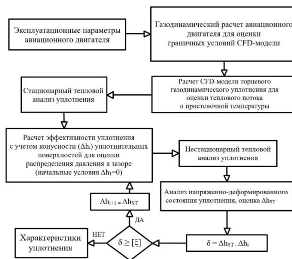
Рисунок 6. Методика расчёта герметичности торцевого газодинамического уплотнения при нестационарном нагружении
