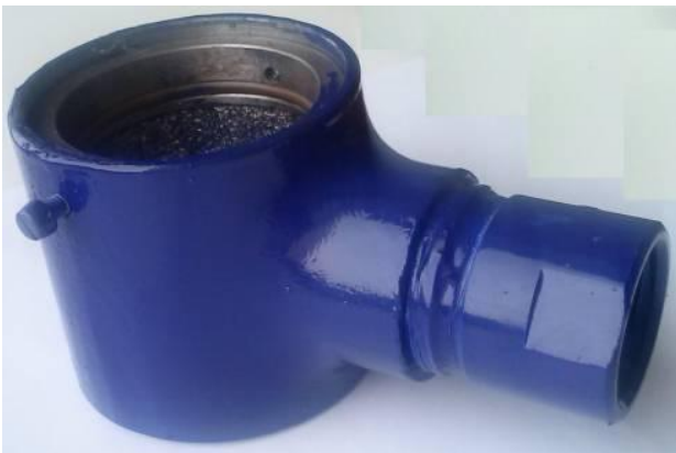
Рисунок 3. Внешний вид опытного образца глушителя шума
