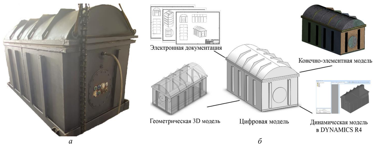
Рисунок 1 – Вакуумный разгонно-балансирующий стенд МАИ: а – общий вид; б – цифровая модель
