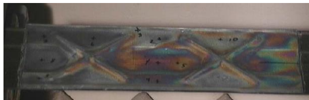
Рисунок 7 – Нагруженное фотоупругое покрытие на створке сопла
