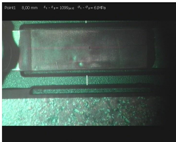
Рисунок 6 – Фото испытания балки с фотоупругим покрытием
