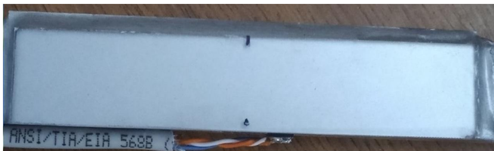
Рисунок 1 – Фрагмент консольной балки, препарированной фотоупругим покрытием
