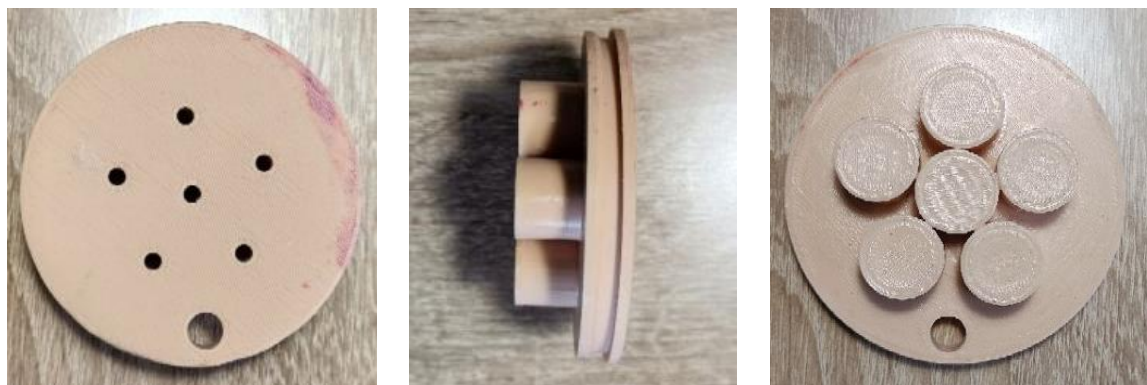
Рисунок 6 – Общий вид экспериментального образца (пример реализации 6-ти резонаторов на одной плите)
