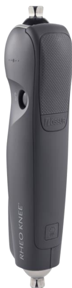
Рисунок 4 – Внешний вид протеза колена RheoKnee с демпфером на основе магнитореологической жидкости
