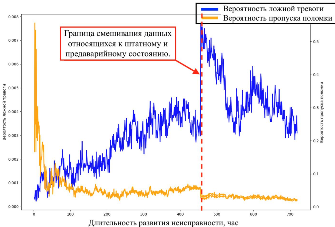
Рисунок 4 – Вероятности ложной тревоги и пропуска поломки при варьировании времени развития неисправности
