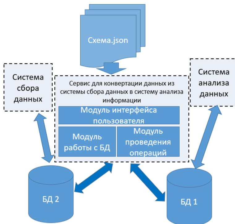
Рисунок 1 – Схема сервиса для обработки и передачи данных
