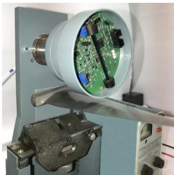
Рисунок 3 – Конструктивное исполнение ОЭДФП для экспериментальных лабораторных исследований
