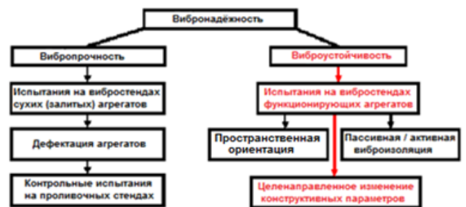
Рисунок 1. Задача обеспечения виброндёжности агрегатов и систем двигателей ЛА. 1 Причины и характеристики вибраций агрегатов двигателей ЛА
