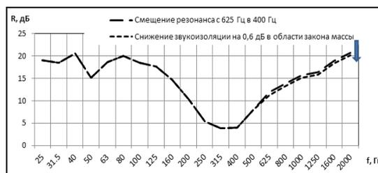
Рисунок 2. Снижение звукоизоляции на 0,6 дБ
