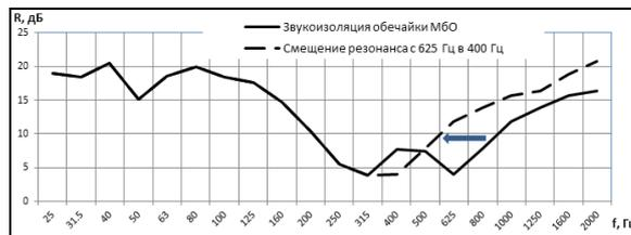
Рисунок 1. Звукоизоляция и резонанс КМ
