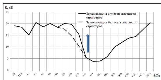
Рисунок 4. Увеличение звукоизоляции в полосе частот 140-250 Гц за счёт учёта жёсткости стрингеров
