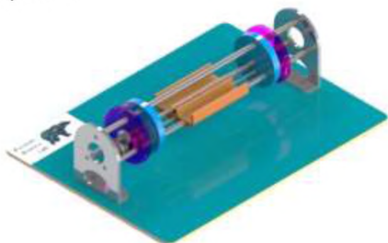
Рисунок 4. Система смещения центра масс
