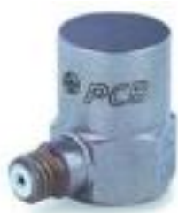
Рисунок 7. Датчик вибрации фирмы PCB
