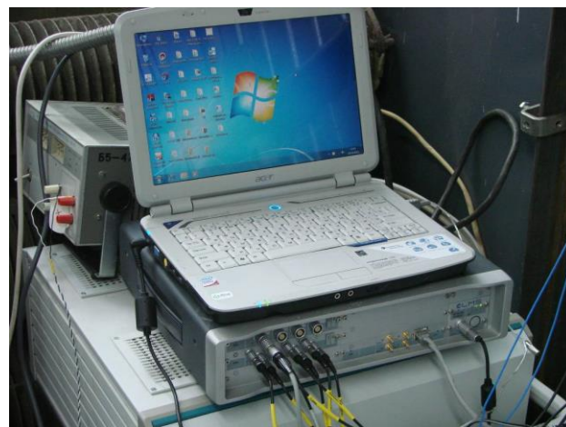
Рисунок 6. Система LMS SCADAS Mobile
