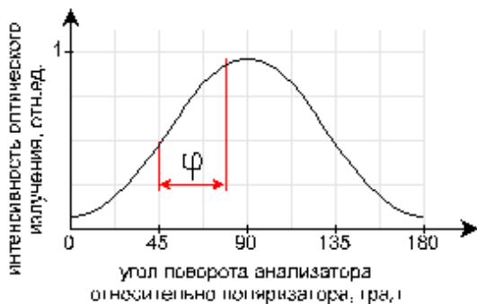
Рисунок 2. Зависимость интенсивности выходного оптического сигнала от угла поворота анализатора при \varphi_{n.a.} = 45^\circ
