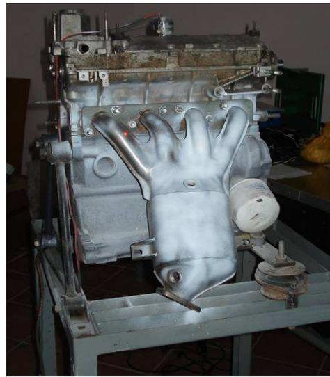
Рисунок 7. Экспериментальная установка по модальному анализу каталитического коллектора
