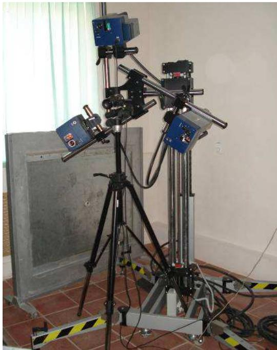
Рисунок 6. Сканирующий лазерный виброметр Polytec PSV-400-3D
