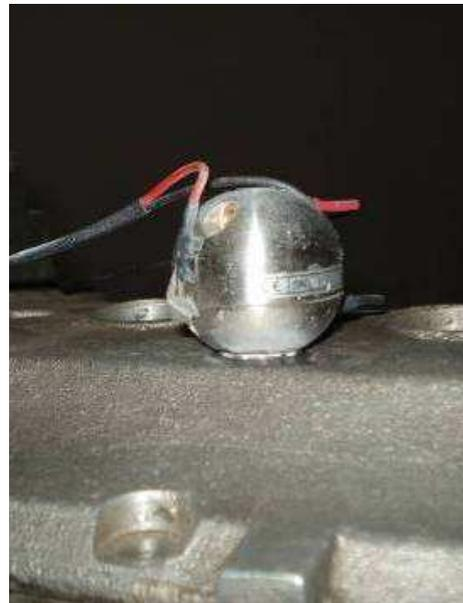
Рисунок 8. Закрепление вибровозбудителя в ходе модального анализа
