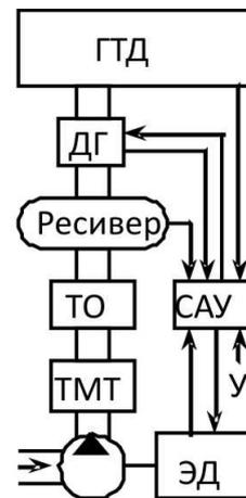
Рисунок 6. САУ НК-361 с двумя независимыми контурами
