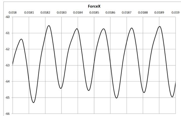
Рисунок 7. Сила, действующая на лопатку соплового аппарата
