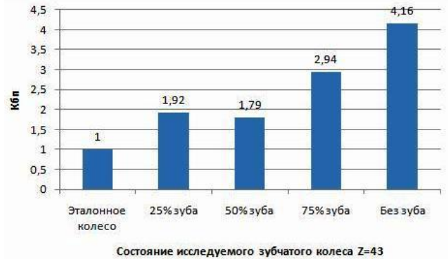
Рисунок 5. Диаграмма изменения показателя K_{bp} для колеса Z=43 при 160 \text{ мин}^{-1}
