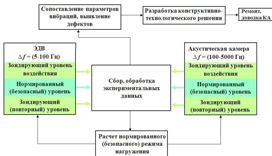
Рисунок 4. Функциональная схема виброакустической диагностики
