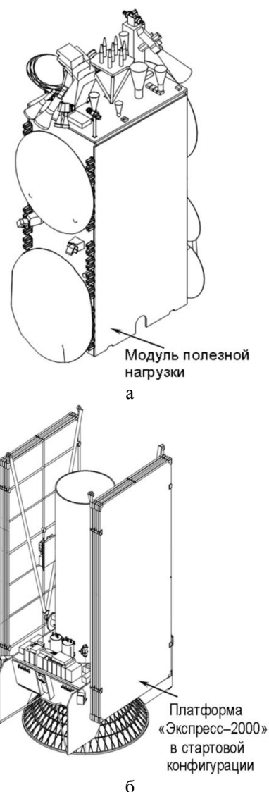
Рисунок 1. Конструктивно-силовые схемы КА открытого исполнения
