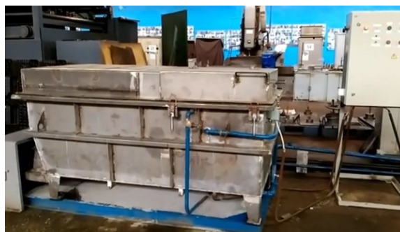
Рисунок 6 Фотография установки для мойки труб при низкочастотной резонансной кавитации на АО «Авиаагрегат» холдинга «Технодинамика»
