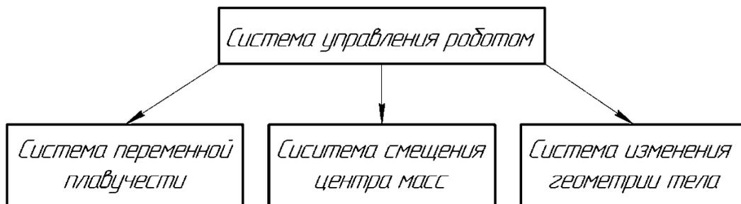
Рисунок 1. Принципиальная схема системы управления
