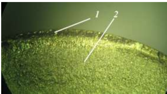
Рисунок 2. Фрагмент излома упрочнённого обкаткой роликом при P = 1,0 кН вала из стали 20: 1 – нераспространяющаяся трещина усталости, 2 – зона долома
