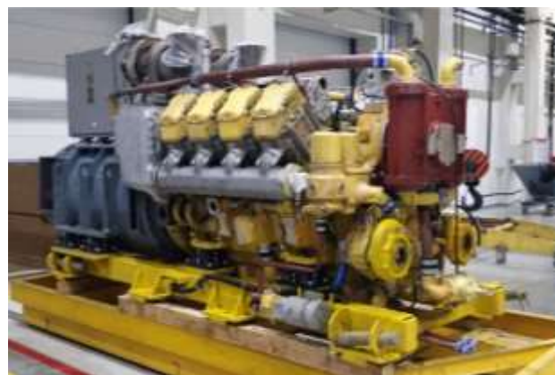
Рисунок 5. Дизель-генератор ДГ-882Л с виброопорами ВЦПД-01
