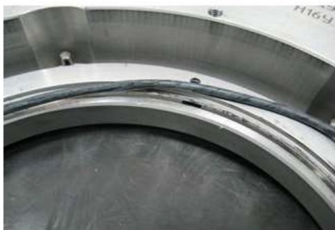
Рисунок 7. Фотография скрученного резинового кольца вторичного уплотнения после аварийного останова стенда
