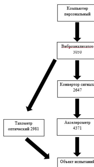
Рисунок 2. Внешний вид измерительной цепи
