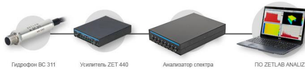
Рисунок 7. Схема подключения гидрофонов
