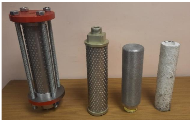
Рисунок 6. Внешний вид испытуемых глушителей
