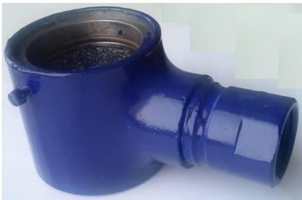
Рисунок 3. Внешний вид опытного образца глушителя шума
