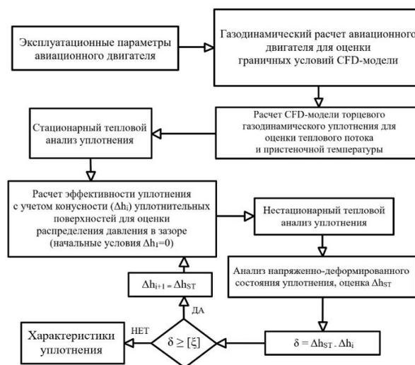
Рисунок 6. Методика расчёта герметичности торцевого газодинамического уплотнения при нестационарном нагружении
