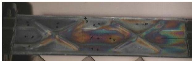
Рисунок 7 – Нагруженное фотоупругое покрытие на створке сопла
