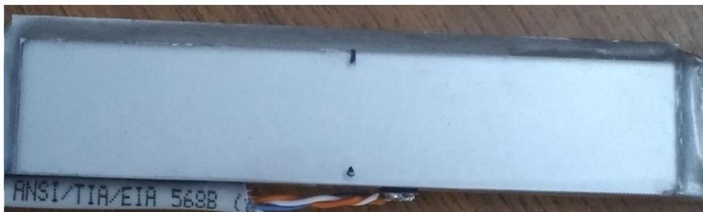
Рисунок 1 – Фрагмент консольной балки, препарированной фотоупругим покрытием
