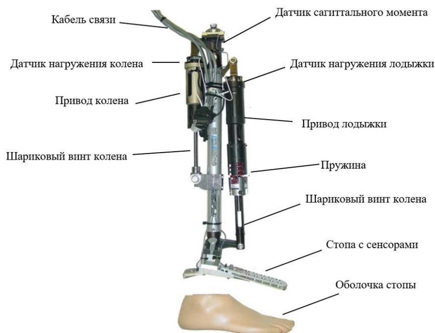
Рисунок 3 – Прототип протеза с кабельным подключением
