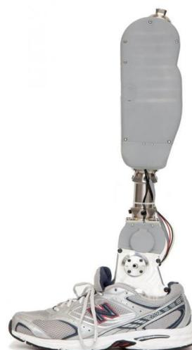
Рисунок 2 – Версия роботизированной ноги, разработанной Центром интеллектуальной мехатроники Университета Вандербильта
