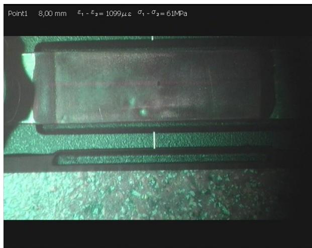
Рисунок 6 – Фото испытания балки с фотоупругим покрытием
