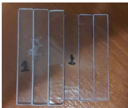
Рисунок 3 – Образцы плоской формы, изготовленные из смолы AQUAGLASSCITRUS
